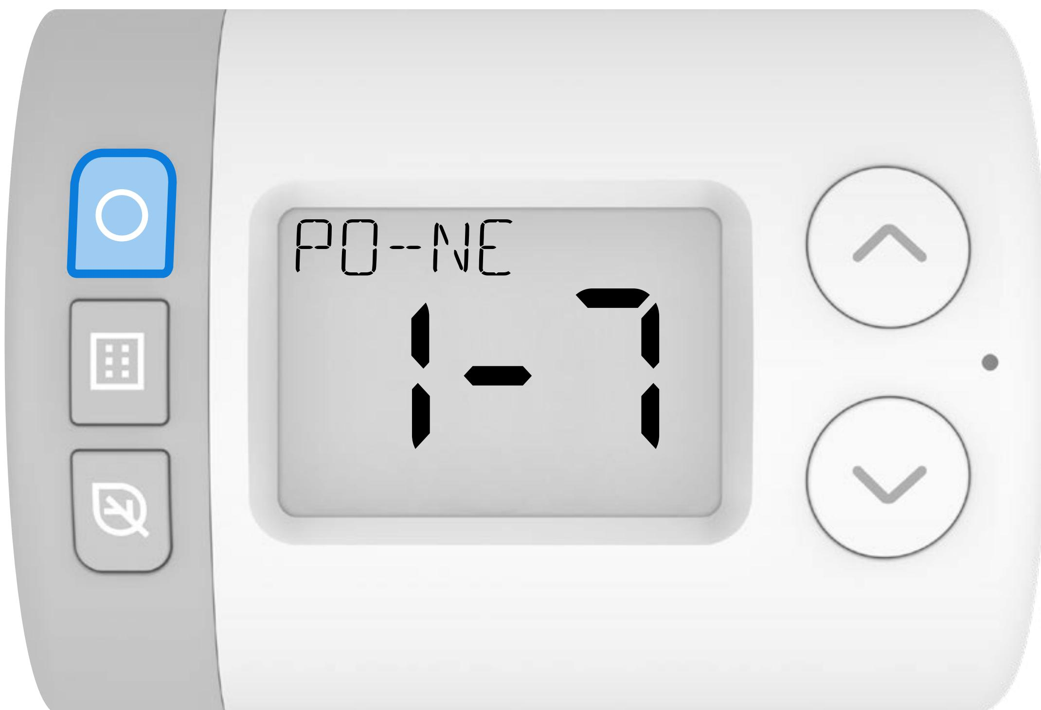
Program lze vytvořit buď pro skupiny dnů, nebo pro jednotlivé dny. Správně vyberte jeden ze tří níže uvedených typů programu – změny provedené pomocí jiného typu programu totiž přepíší všechny předchozí změny.
