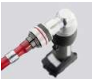
3. Rozšíření trubky zastudena expandérem 2x. Druhé rozšíření po otočení expandéru o 30°.
